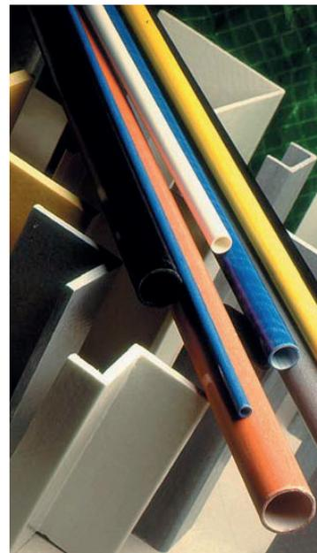
Les profilés en polyester renforcé de fibres de verre sont obtenus par pultrusion. La pultrusion est un procédé continu dans lequel un polymère therm durcissable et des fibres de renforcement sont formés en un profilé.
