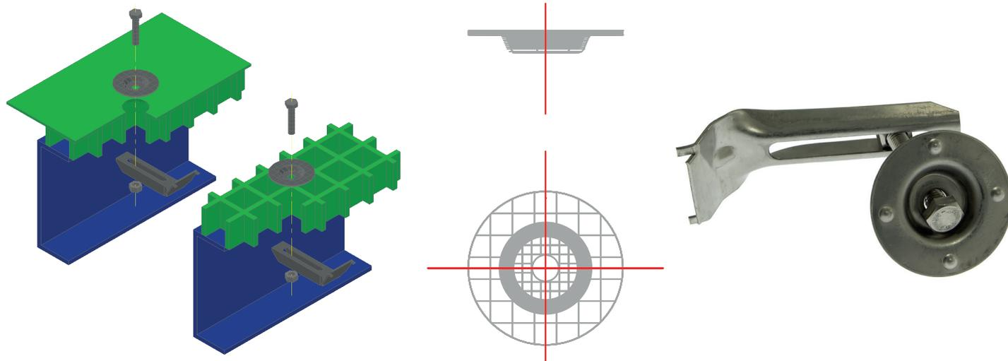
L'attache O-clip complète est utilisé pour la fixation de caillebotis ouverts et fermée avec mailles 38 x38 / 40x40 par serrage sur le profile porteur. Ce clip est facile à installer sans percer dans la sous-structure
